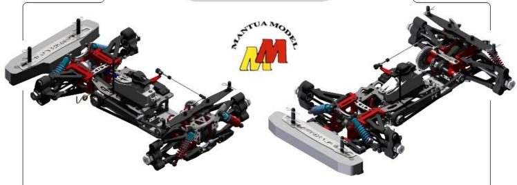
MANTUA MODEL CAMPIONE ITALIANA AMSCI 2011 cat. F1 e F2 E'importantissimo usare il frenafiletti estremo (verde) sui 4 grani di battuta dei finecorsa. Questi vanno avvitati dal basso verso l'alto, arrivando a liscio telaio nella parte superiore.
